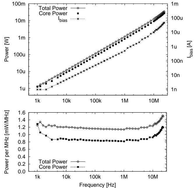
Fig. 13. ADC power scaling,  $V_{\text{supp}}=3 \text{ V}$ .
